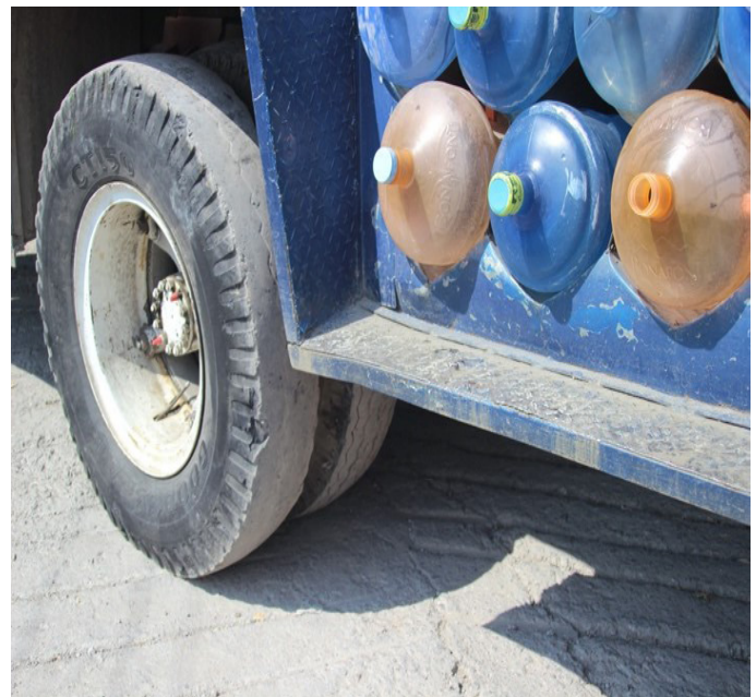
Figura 11. Neumáticos de camiones pesados en mal estado.
