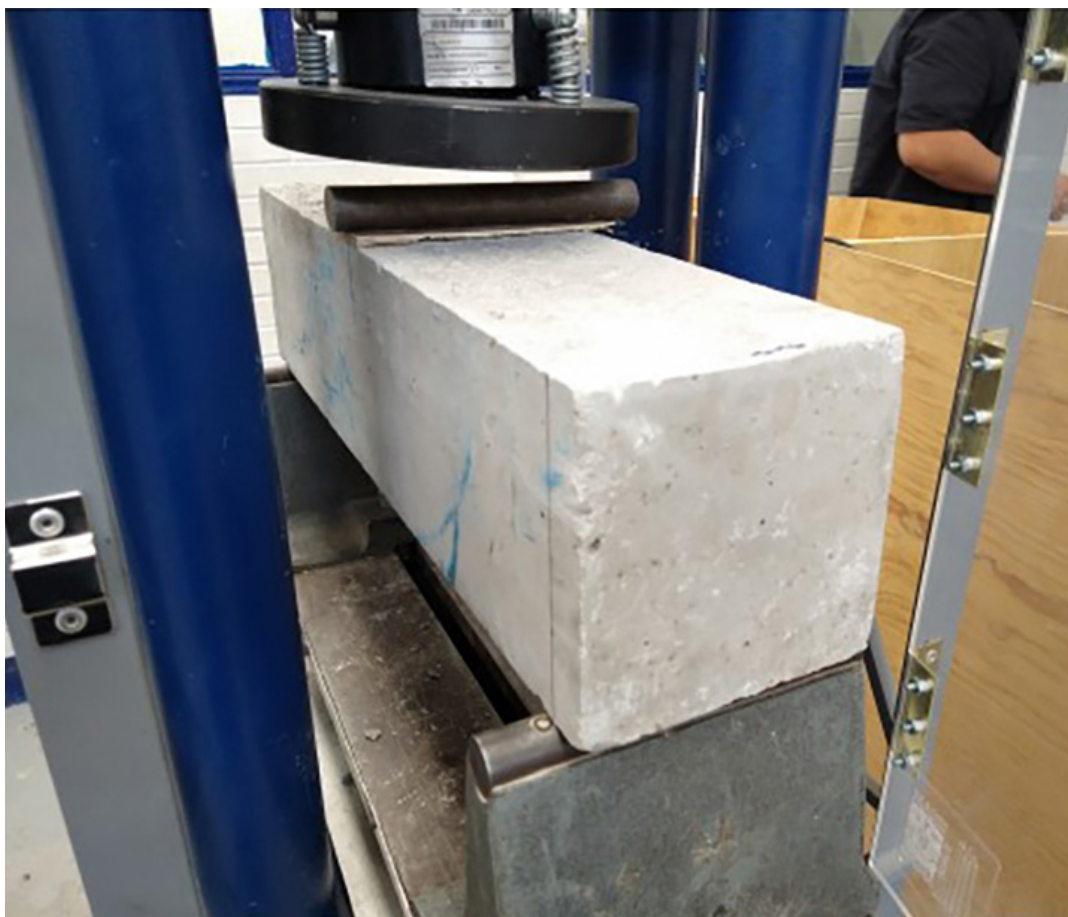
Figura 8. Prueba de flexión.
