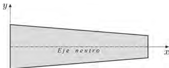
Figura 1. Viga ahusada. Elaboración: Jaime Retama Velasco.
