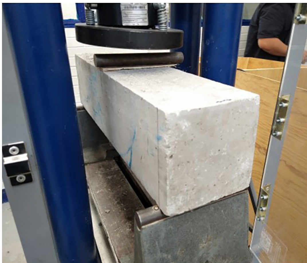
Figura 8. Prueba de flexión.
